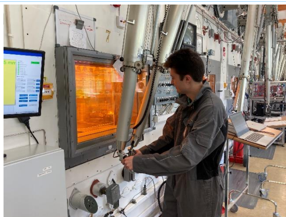
Figur 1 En hot cell på Studsvik AB
