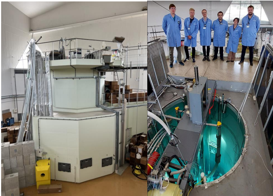
Figur 2. Vänster: TRIGA-reaktorn i mitten av dess överbyggnad. Höger: Guiden Janez och gruppen ovanpå reaktorn vid den öppna reaktorbassängen.
