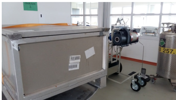
Mätinstrument för att friklassa material. Foto: Privat
